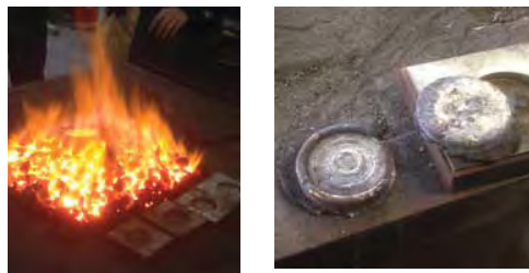
図3 金属の溶解・鋳込み
